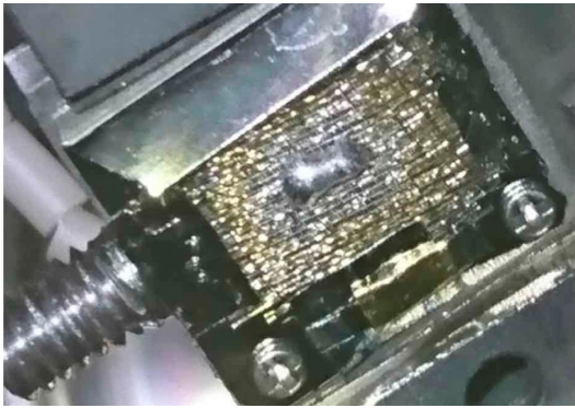
図3 スパッタリング清浄化後の GaIn 液体金属試料 (室温、超高真空中)
