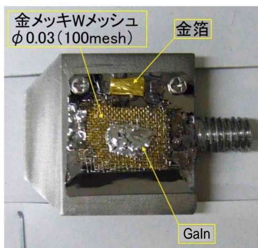
図1 GaIn 液体金属用サンプルホルダー
