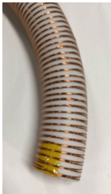
図3 40倍スケールで作成したベクトルポテンシャル生成コイルの写真。巻き線部には2つのらせんを掘り込んだ形状で、2分割したパーツを連結してベクトルポテンシャル生成コイルとする。
