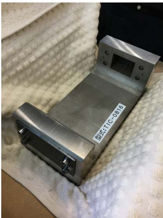
図1 製作した中性子コリメータ。2枚のガドリニウム板が治具の前後に固定されている。
