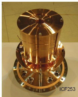
図5 製作した平面グリッド RFA。写真は、磁気シールドを取り外した状態。
