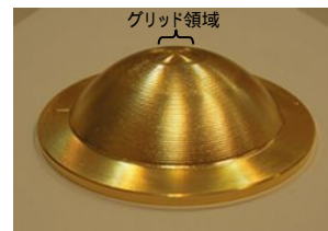
図 4 製作したドーム状電極。頂上付近には多数の貫通穴が球中心に向けて開けられている。
