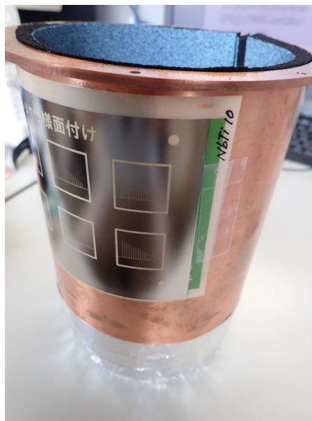
希釈冷凍機の内部の輻射シールドに作成したMKIDをはり付けた。このような曲面への貼り付けが可能である。
