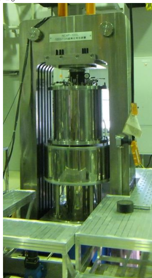
図4：2段式圧力発生部をセットした装置全体の写真
