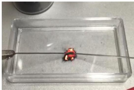
図 6 Ti/SiO ナノ粒子群の発熱反応の様子
