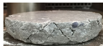
図2 古紙パルプ繊維で強化された繊維強化氷の破壊例 (JST A-STEP FS タイプ 課題番号 AS262Z00874K「パイクリートをを用いた革
