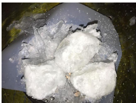
図3 ナノセルロースで強化された繊維強化氷の破壊例
