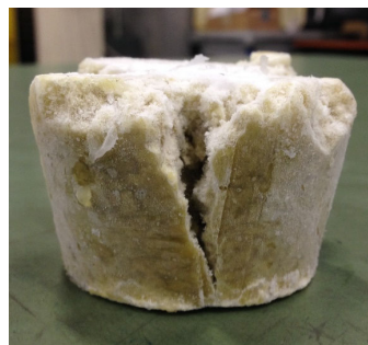
図5 ガラス繊維で強化された繊維強化氷の破壊例(Cw=30wt%、クロスヘッド速度 100mm/min、金型温度 -30^{\circ}\text{C} 、実験実施温度室温)
