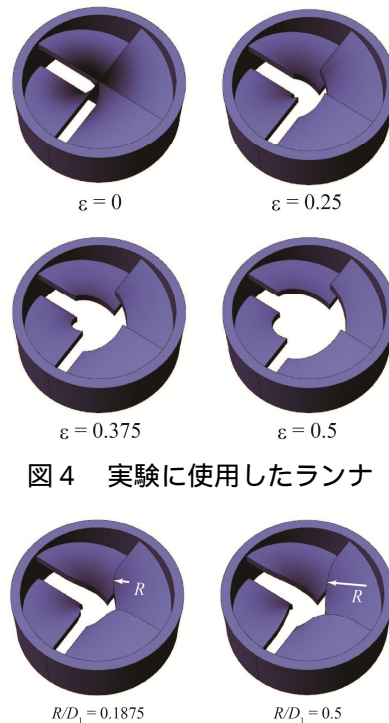
図5 羽根先端に丸みをもたせたランナ
