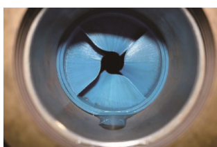
図 11 丸みが付与されたランナの撮影結果
