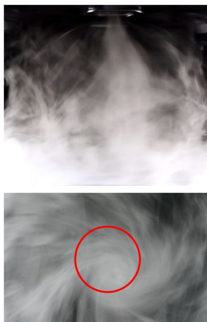
図6 ドライアイスミストによる流れの可視化写真 ( R = 8 mm, N = 120 rpm, Q = 100 m 3 /h (上: 鉛直断面, 下: 下壁近傍の水平断面, 赤丸は渦芯の振れ回り範囲))
