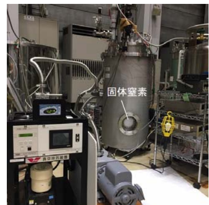
図7 固体窒素完成時のクライオスタット観測窓の様子
