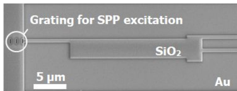
(a) 作製した分波器の SEM 写真（シリコン上に蒸着された Au 膜上に SiO 2 膜を堆積し、SiO 2 膜のみをパターンニングして作製）
