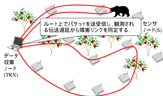
図1 反射型遅延トモグラフィの原理。
