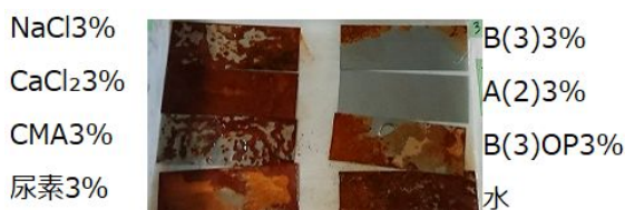
図 6 腐食生成の様子 (7 日目)
