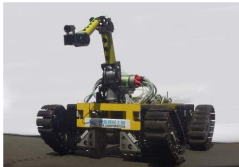
写真1: 大水深対応型水中作業ロボット「DEEP CRAWLER」(東亜建設工業(株))
