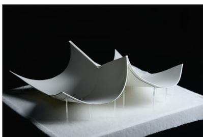
図2: 可展面を接続した自由曲面シェルの模型
