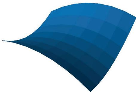
図3: ひずみ制約の下でガウス曲率を最小化して得られた疑似可展面の例
