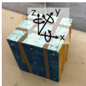
図3 ブラフボディ試験体 写真は立方体模型で自立型計測装置を内蔵する
