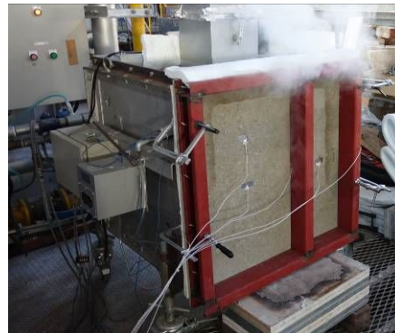
図1 部材試験の様子（硬質木片セメント板）
