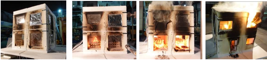
(a)南東側（点火前） (b)南側（点火直後） (c)南側（15分経過） (d)北側（28分経過） （2階寝室1へ延焼） （2階スタジオ盛期）
