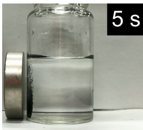
Fig. 3 PBおよびFe 3 O 4 を同時固定し調製した球状吸着剤のネオジウム磁石による回収試験
