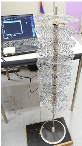
図 1 ダイオードツリーの外観
