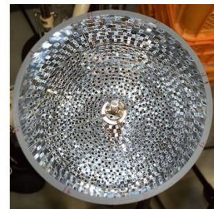
図 2 鏡面仕上げした円筒内部のダイオードツリー
