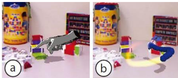
図 1. 卓上の遠隔協調作業において、モバイル端末上に (a) 手の 3 次元形状、(b) 指先の軌跡を表示した例 [1].
