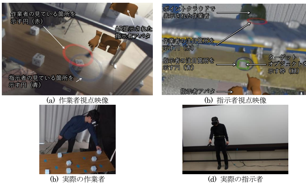
図 5. 対話者の身振り手振り、視線（注目箇所）を伝達可能な AR 遠隔協調作業システム.
