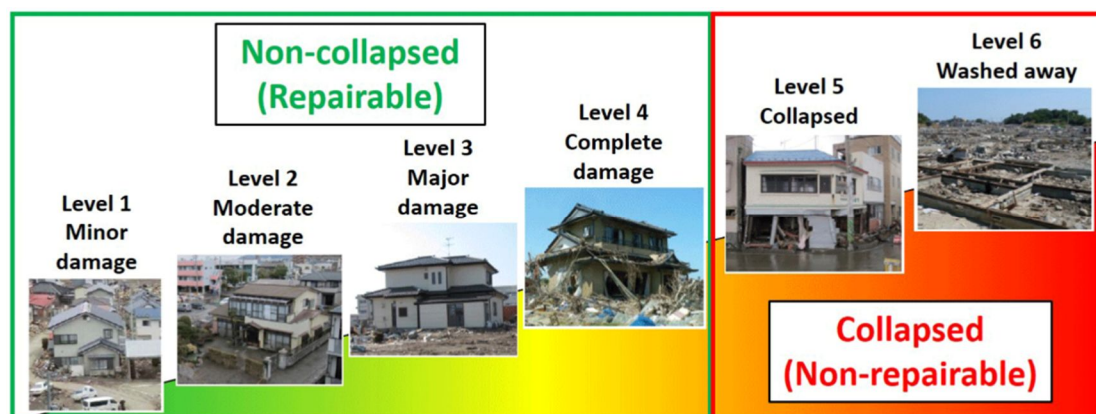
図 3 建物の被害レベルと本研究で検討した「倒壊」条件
