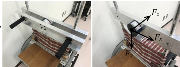
図1 介助力計測用の車椅子のハンドル部
