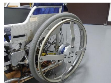
図2 車軸上への力覚センサ設置
