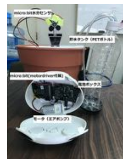
図 15 プログラミング教材を用いた自動灌水装置の製作例
