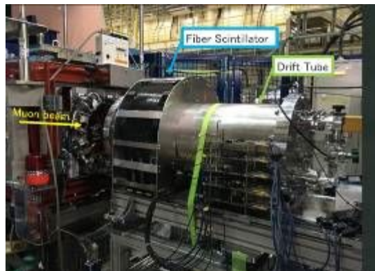
図 2 : MLF S1 ミュオンビームラインにおける実験装置配置。
