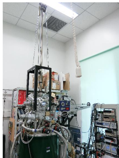
図1: 磁場中電気伝導測定用超高真空クライオスタットの外観。
