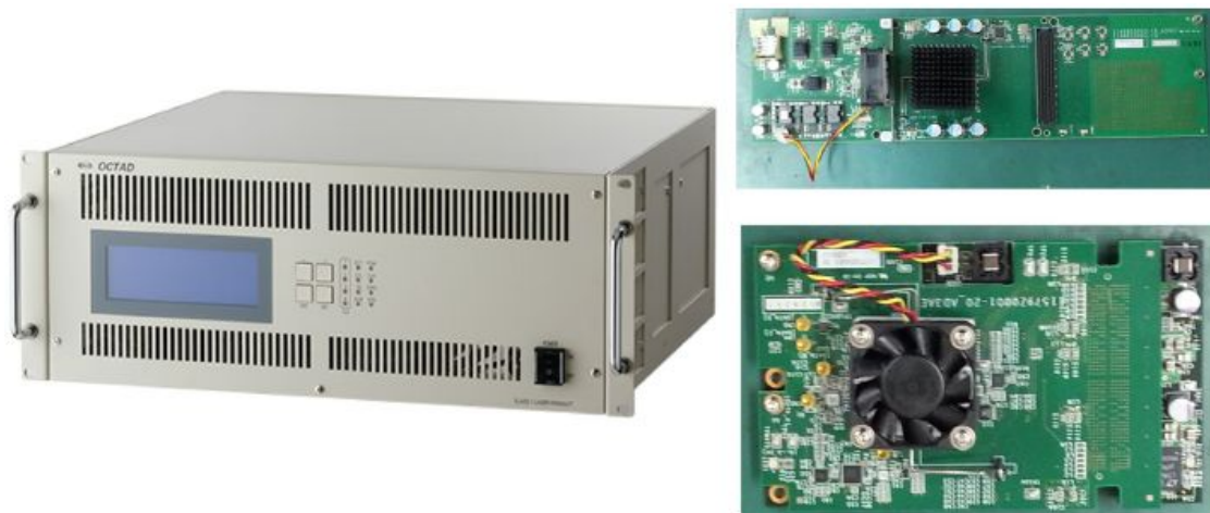
図2 本研究で開発・製品化されたデジタル分光計（雑誌論文1より）
