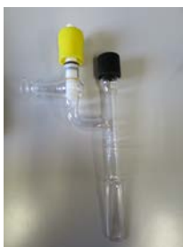
図2 設計・製作した気相反応容器
