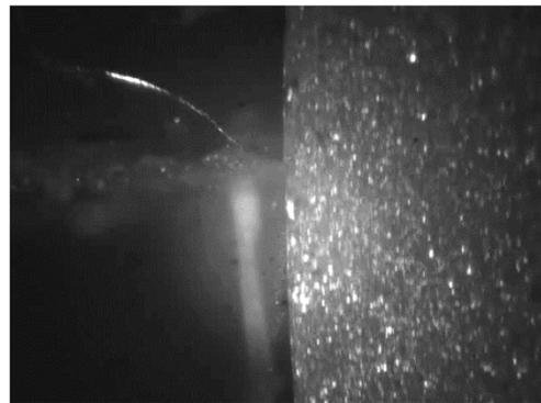
図 9 送り停止時の弾性回復による切りくず生成
