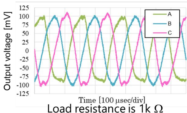
図4 作製した発電機の出力波形
