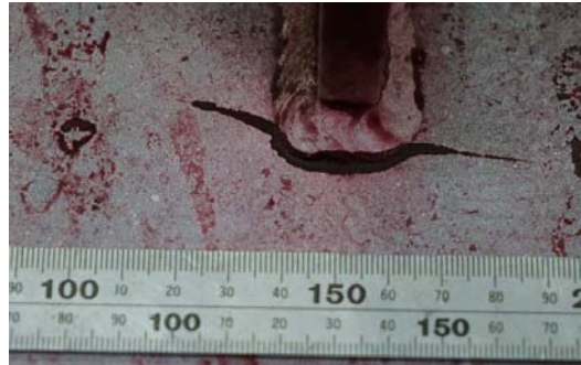
写真 5 浸透探傷試験結果
