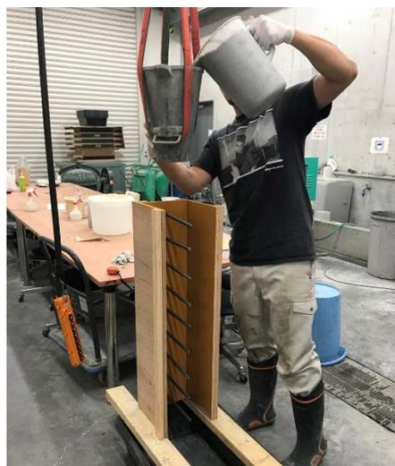
写真 1 逸失モルタル量の測定
