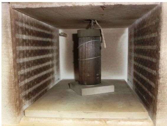
写真1 円柱状スギサンプル加熱実験の試験終了後のサンプルの様子 (直径50mm、窒素雰囲気下、300一定)
