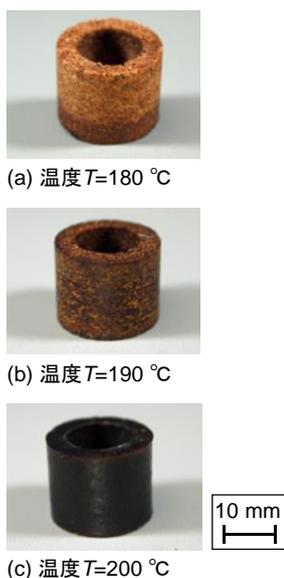
図8 金型温度  $T$  が容器の外観に及ぼす影響 (バインダ: スクロース, バインダ含有率  $B=40\text{ wt\%}$ ,  $d=0.5\text{ mm}$  以下)
