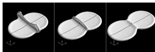
図 4 2 つ液滴の衝突時の挙動. (左) L = 1.2D , (中央) 1.6D , (右) 2.2D .
