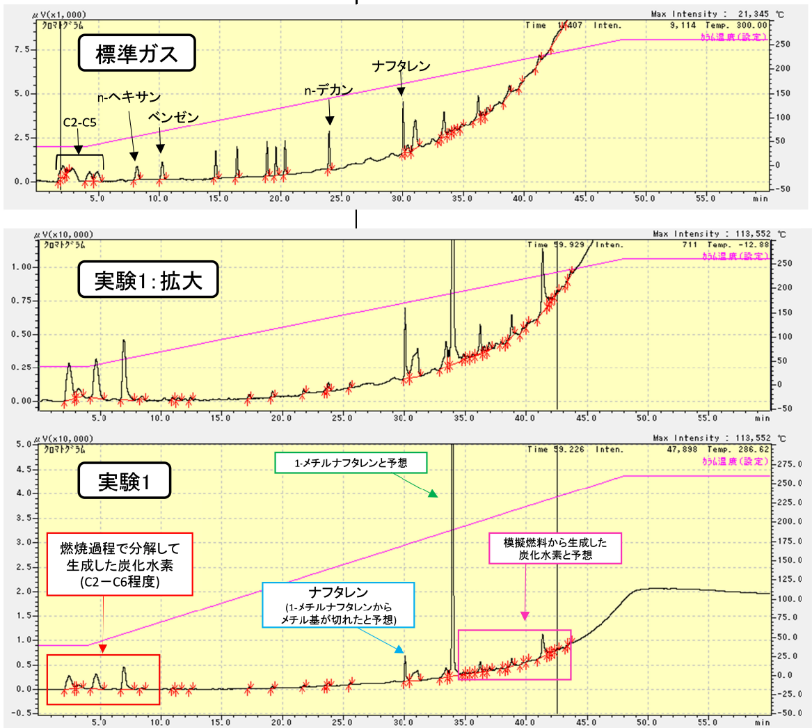
図 2 排ガスに含まれる炭化水素の分析結果と標準ガスの比較
