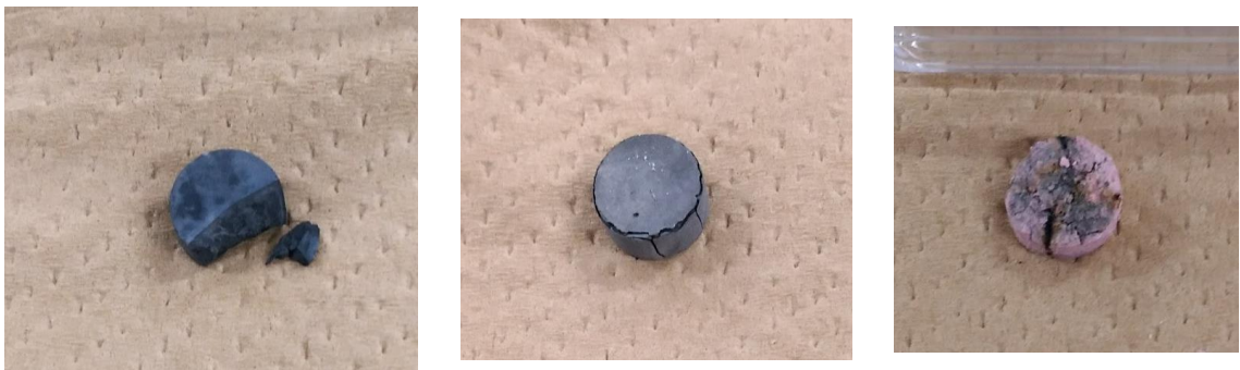
図 2 : 浸漬試験後・水洗後の Er 2 O 3 タブレット 550°C28 日間 左 : 純 Li 中 中 : Li-Na 中 右 : 純 Na 中
