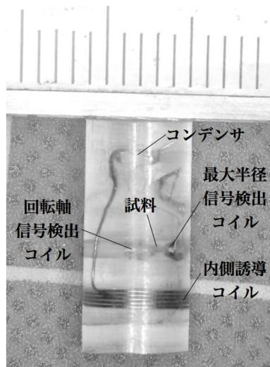
図2：6.5mm 遠心管用サンプルセットアップ
