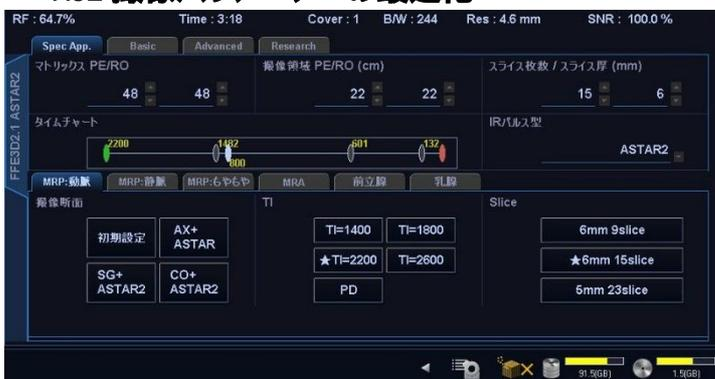
tag IR : inversion pulse for tag region、control IR : inversion pulse for control region to cancel MT effects、TEC : saturation pulse for tag region(tag end cut: TEC) to suppress inflow blood signal、nss-IR : non-slice selective IR pulse for background suppression などのパラメーターを TI を変更することにより最適の状態に調整する必要があるため Canon メディカルシステムズと共同で ASL-Navi (撮像支援ソフトウェア) の作成を行った。これにより TI の簡便な変更ができるようになった。
