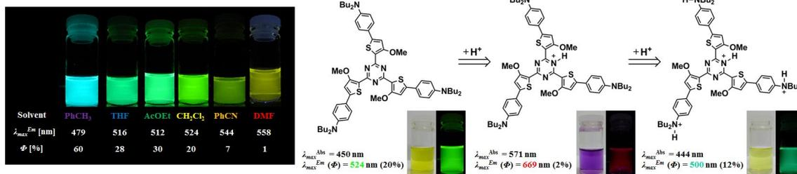
図 3 化合物 3 のフルオロソルバトクロミズム特性並びにプロトンセンシング特性
