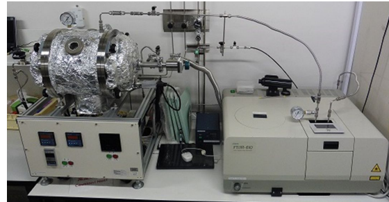
図 2 炭化反応メカニズム解析のために構築した炉内ガス分析システム。小型反応装置(左)と赤外分光吸収装置(右)からなる。
