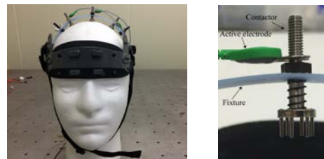
図4 試作したアクティブ電極固定用ヘッドマウント(左)と接触子(右)
