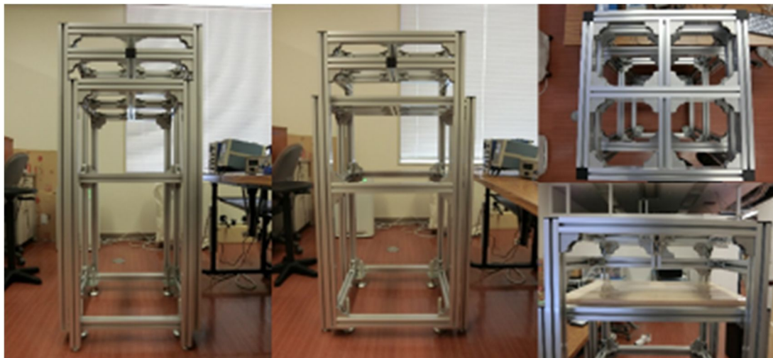
図 2 刺激量定量化装置．正面（左），側面（中），天面（右上），加振機固定部（右下）
