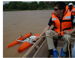
図-3: ADCP による河川測量
