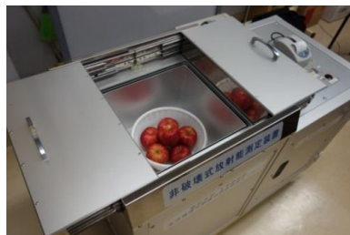
PET 技術に応用した丸ごと放射能汚染検査装置 (福島市内)
