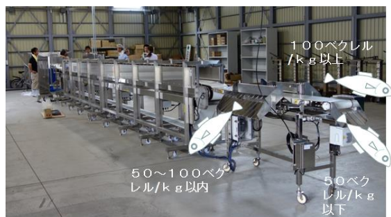
PET 技術に応用した魚丸ごと放射能汚染連続検査装置 (石巻漁港)
