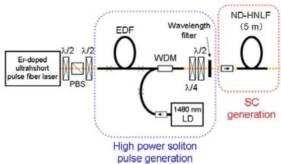
図5 高精度スーパーコンティニューム光源の構成
