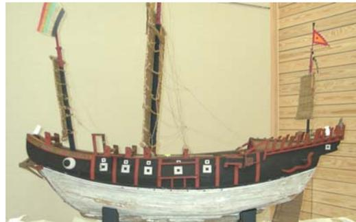
(2) 船型の計測：この選定された琉球進貢船の模型について、最新の測量計測方法であるトータルレーザーステーションを使用し、工学検討の基本となる船体形状の計測を行い、数値化、コンピュータによる3次元の形状再現を行った。九州国立博物館で行われた計測では、長さ約1.5mの小型模型に対して数百点の形状計測を行い、船型はもとより艀装品の形状、配置などにわたる詳細なデータの計測とCADによるデータ解析を行い、線図、オ
