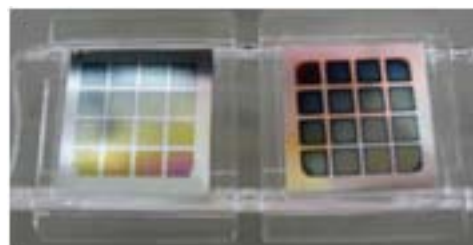
図3 CCS-PLD 法で作成した混合正極薄膜ライブラリ
