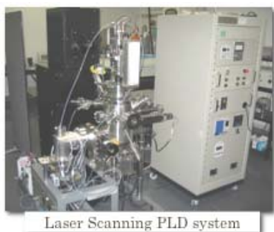
図1 本研究で開発導入されたレーザースキャン PLD システム
