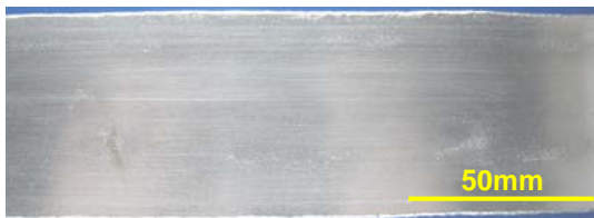
図6 双ロール鋳造材の表面概観
