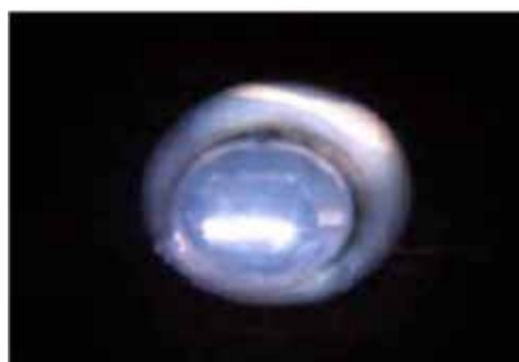
図 4 亜臨界水中プラズマ放電写真
